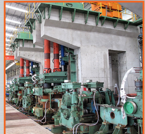
เครื่องรีดเหล็กเส้นอัตโนมัติ Automatic Rolling Mill
