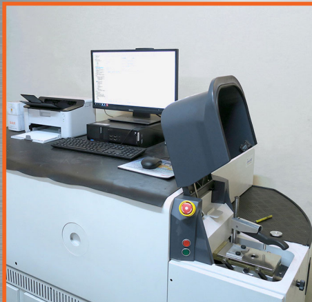
เครื่องตรวจสอบส่วนประกอบทางเคมี Spectrometer
