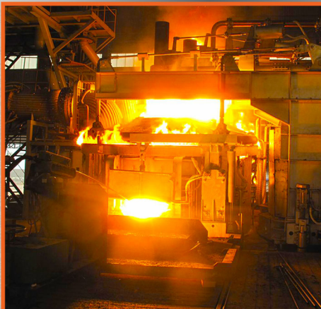
เหล็กหลอมละลาย อุณหภูมิประมาณ 1,600 °C Melted Steel Minimum Temperature 1,600 °C
